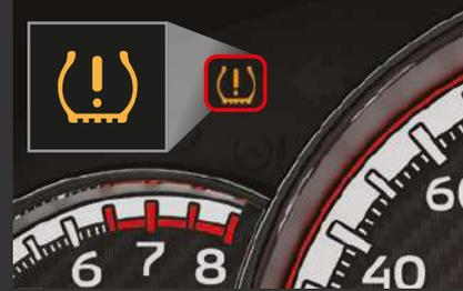
El TPMS utiliza sensores-transmisores en las ruedas para controlar la presión de los neumáticos y enciende una luz de emergencia en el tablero de cuentarrevoluciones. En el caso de que uno o más neumáticos estén presentando una presión baja.
