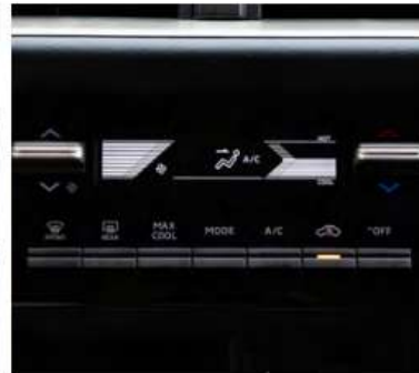
Control de aire acondicionado digital
