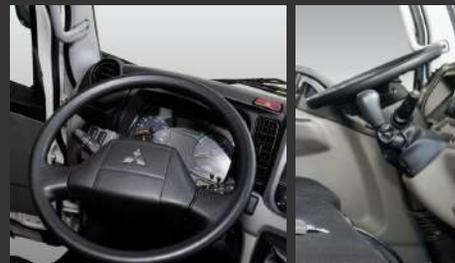
El volante regulable en inclinación y telescópico y palanca de cambios en el tablero para una posición de conducción óptima
